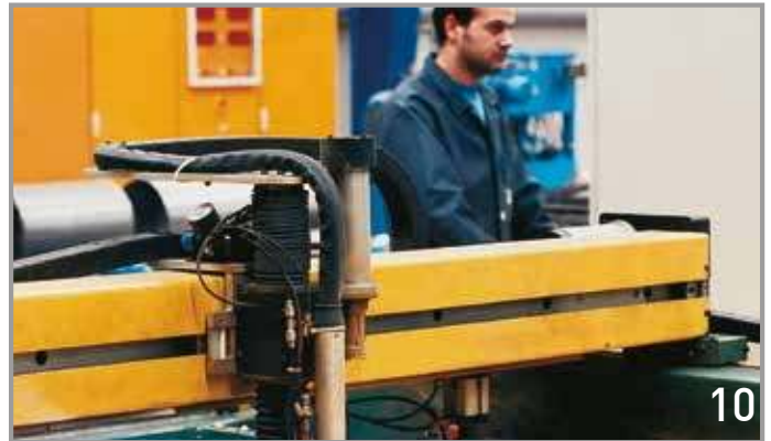
10. Αυτόματη μηχανή οριζόντιας συγκόλλησης των δεξαμενών / Automatic welding machine of the storage tank
