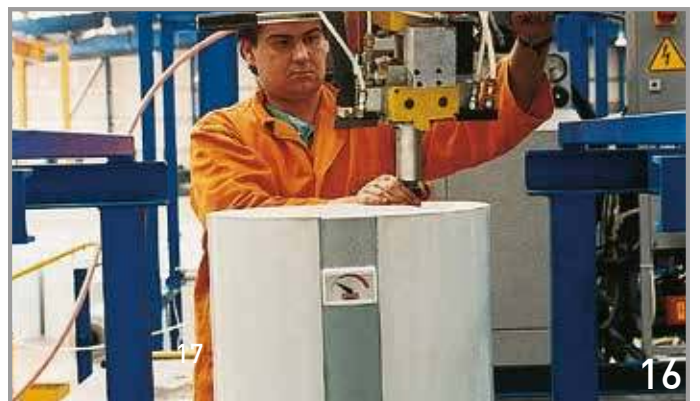
16. Συναρμολόγηση δοχείων / Assembly of storage tanks
