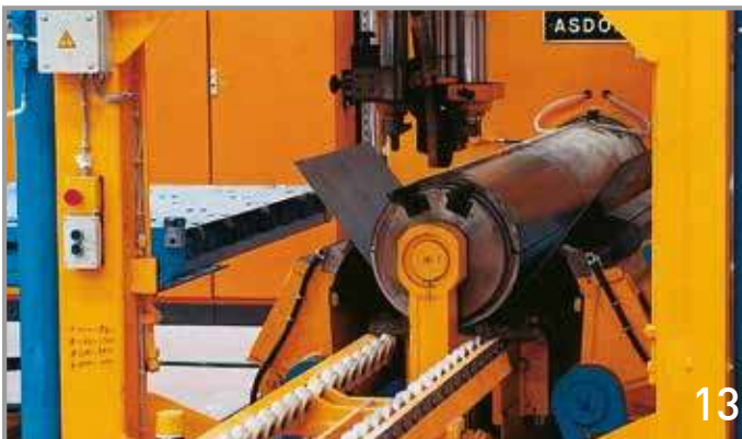
13. Ρομπότ διαμόρφωσης και συγκόλλησης κυλινδρών για μέγιστη ακρίβεια και ποιότητα / Cylinder forming and welding machine for maximum precision and quality
