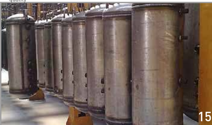
15. Δοχεία έτοιμα για φάση μεταλλοβολής / Tanks ready for metal blasting
