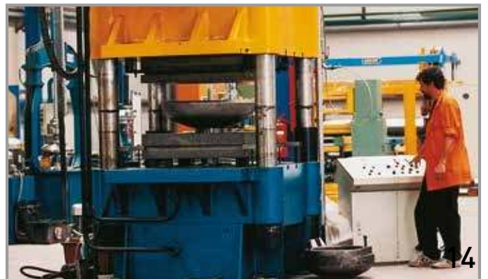
14. Υδραυλική πρέσα διαμόρφωσης καπακιών / Hydraulic press for forming superior and inferior caps
