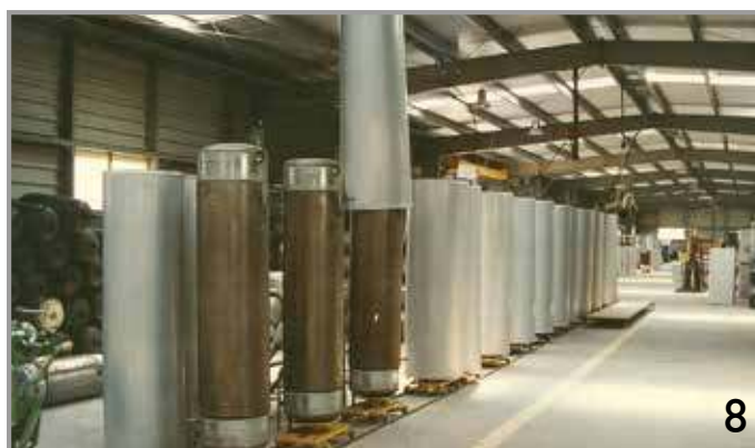
8. Συναρμολόγηση δοχείων / Assembly of storage tanks
