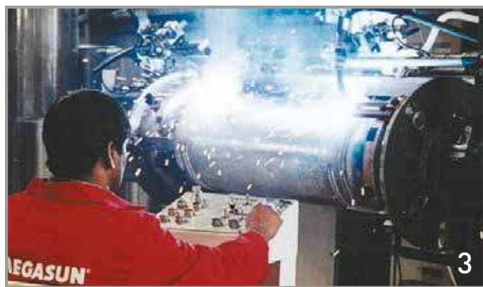
3. Αυτόματη μηχανή παραμετρικής συγκόλλησης των δεξαμενών / Automatic welding machine of the storage tank side covers
