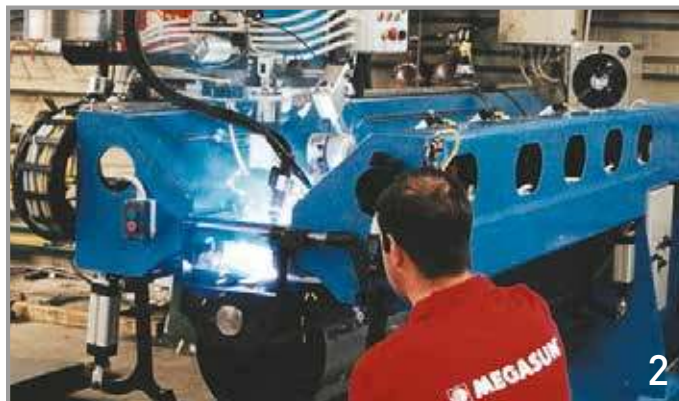
2. Αυτόματη μηχανή οριζόντιας συγκόλλησης των δεξαμενών / Automatic welding machine of the storage tank
