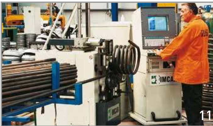
11. Αυτόματη παραγωγή εναλλάκτη με ηλεκτρονικούς υπολογιστές / Computerised automated heat exchanger production
