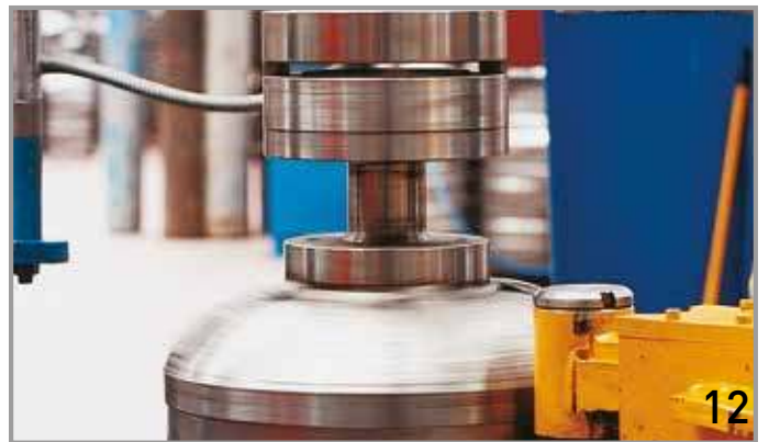
12. Αυτόματη διαδικασία περιμετρικής κοπής και διαμόρφωσης καπακιών / Automated cutting and final formation procedure of the caps
